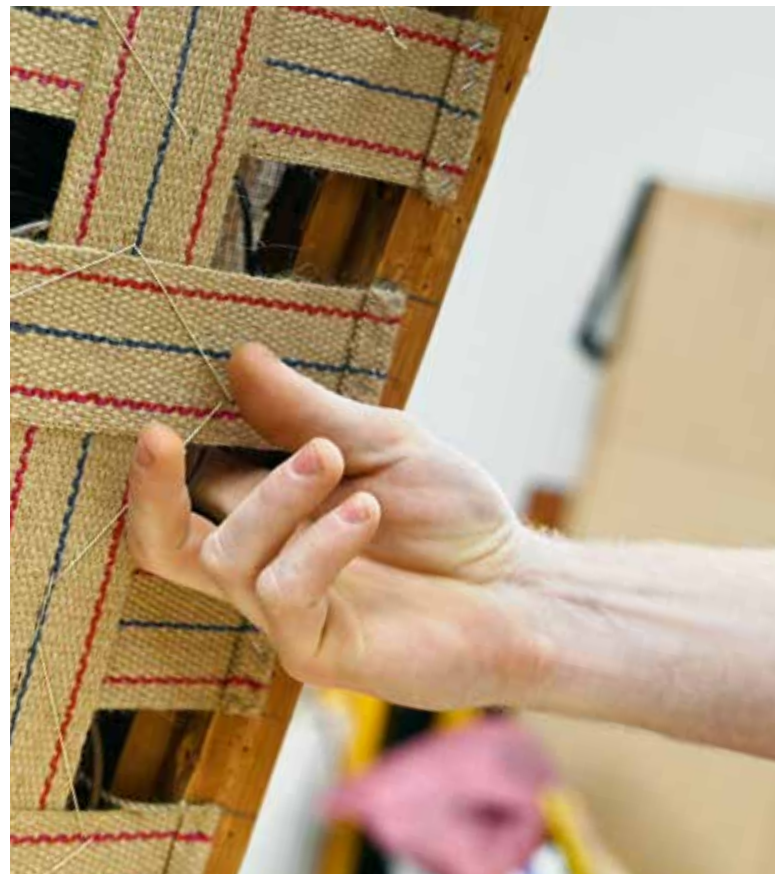
Die Basis der klassischen Schnürung bildet ein Geflecht von Jutebändern, auf dem die Federn von Hand festgenäht werden.
